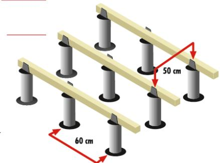
Absolut unempfindlich gegen Wasser und Frost. Abgerundeter Tellerboden. Öffnungen und Stege lassen das Wasser kontrolliert ablaufen - keine Stauässe. Der Träger ist auch unter Belastung justierbar. Bei gedämmten Flachdächern ist auf die Druckfestigkeit der Dämmung zu achten. Hier empfehlen wir Eigenversuche zu machen. Gegebenenfalls kann ein sogenannter Waldboden-Effekt durch eine höhere Lastverteilung auf unserer TuKon-Aluschiene reduziert werden.
