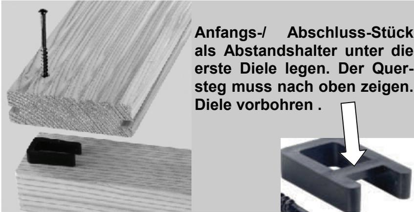
Anfangs-/ Abschluss-Stück als Abstandshalter unter die erste Diele legen. Der Quersteg muss nach oben zeigen. Diele vorbohren .
