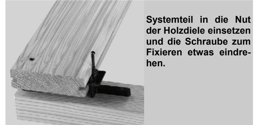
Systemteil in die Nut der Holzdiele einsetzen und die Schraube zum Fixieren etwas eindrehen.
