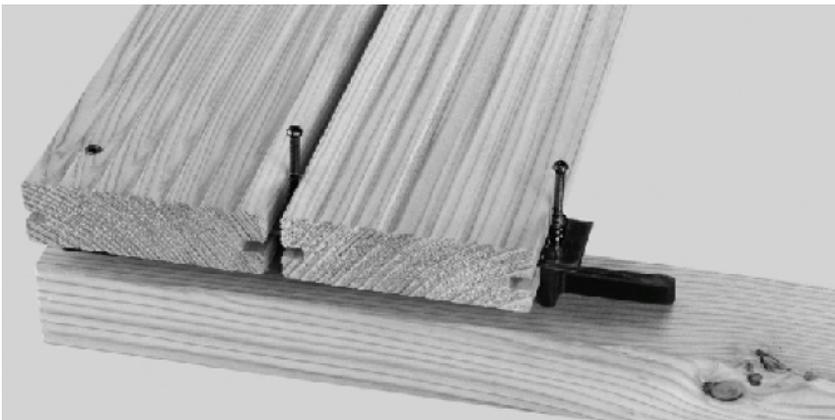
Die nächsten Dielen ansetzen, ausrichten, fixieren und mit der vorherigen Diele verschrauben. Achten Sie auf die richtige Drehmoment-Einstellung Ihres Werkzeuges. Die Schrauben nicht überdrehen. Ein Nachjustieren ist jederzeit möglich.
