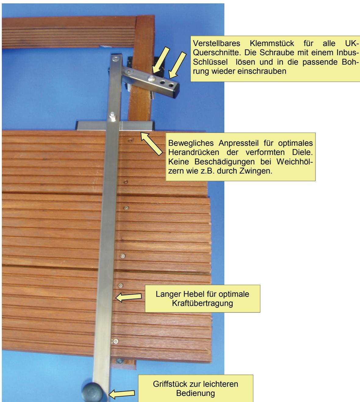
Zuerst wird die verformte Diele an einer Stelle mit einer Schraube fixiert (in unserem Beispiel links **sh. Pfeil 1**).
